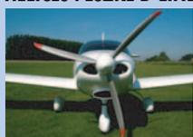
Hélices aéro-élastiques hautes performances de 50 à 160ch. Tripales carbone de 1,56 à 1,82m. Poids de 3 à 3,4kg.
