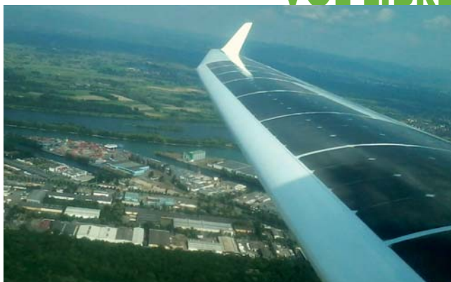
Motoplaneur solaire de Francis Marlier. Aile recouverte de 6,2m 2 de cellules photovoltaïques qui permettent de recharger les batteries de 40Ah en 2 à 3 heures.
