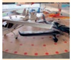
Le plateau tournant s'adapte à tout hangar et permet une exploitation optimale. Réduction des risques de dommages lors de manœuvres. Idéal pour les aérodromes.
