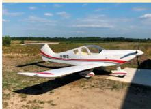
Distributeur des ULM SPACEK: Performance et légèreté, construction bois-carbone, aile basse, empennage en T. Dispo en kit intermédiaire ou avancé, kit motorisation ou prêts à voler.
