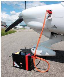
MEGABOOST AVIATION est une gamme de GPUs pour les ateliers de maintenance, aéroports, handlings et pilotes : Groupe de démarrage et alimentation 28V pour avionique. [www.bv-corporation.com](http://www.bv-corporation.com)
