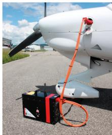
MEGABOOST AVIATION est une gamme de GPUs pour les ateliers de maintenance, aéroports, handlings et pilotes : Groupe de démarrage et alimentation 28V pour avionique.
