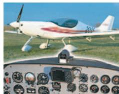
912SFR, tout carbone 2 x 55 L, volets, trim, ailerons et profondeur électriques, radio, transpondeur, horiz, coisière 135kt. 1600 km
