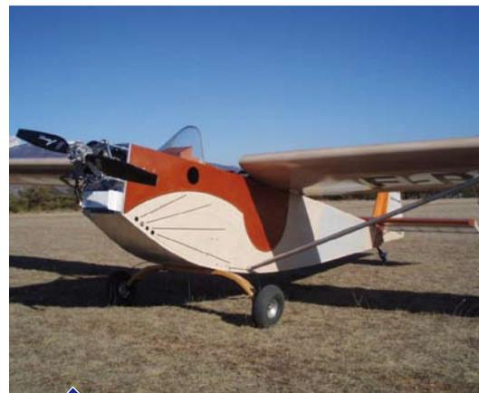
«Electra», 1<sup>er</sup> avion à moteur électrique
