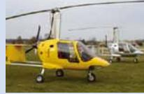
Biplace côte à côte. Hélice tri-carbone DUC VHF FILSER ATR 500. Distributeur XENON France Sud AIR COPTER. Aérodrome MURET.
