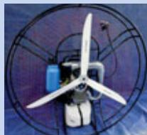
Hélices aéro-élastiques 10 à 50cv Bi- et tripales carbone de 1,25 à 1,46m. Pas fixe ou réglable au sol.
